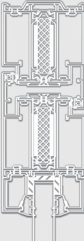
По своему внешнему виду, противопожарная перегородка ничем не отличается от обычной. Системы СИАЛ КПТ78EI и КПТ60EI могут служить как для наружного остекления, так и для разделения внутреннего пространства здания. Остекление может вестись как снаружи, так и изнутри.
