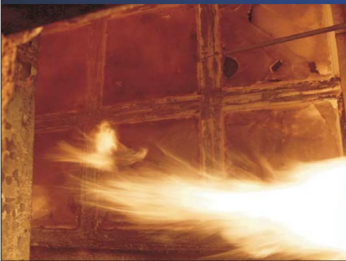
**Заполнение** может быть толщиной от 6 до 50 мм. В качестве заполнения может использоваться специальное многослойное огнестойкое стекло или другое заполнение, имеющее сертификат пожарной безопасности и прошедшее натурные испытания согласно существующим методикам.
